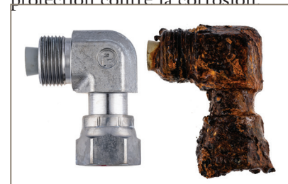
Figure 9: Adaptateurs orientables ToughShield Plus (à gauche) et sertis en zinc (à droite) après un SST de 3 000 heures
