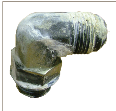
Figure 5 : Oxydation du zinc sur un raccord de tube en acier
